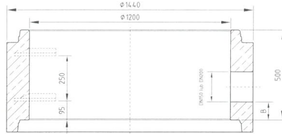
krąg z wlotem: SR-M-WI-1200x500 SR-M-WII-1200x500 ciężar: 700 kg
